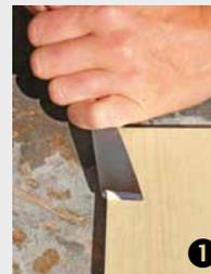
Als Beispiel für die Vorteile dieser Technik wollen wir uns ein schräg angeschliffenes Balleisen ansehen (siehe Abb. 1). Dieses kann dazu dienen, schwer erreichbare Ecken sauber auszuputzen. Gleichzeitig bewirkt es aber auch durch seinen schrägen Schliff, dass es automatisch in einem ca. 60°-Schnittwinkel zum Holz angesetzt wird und dadurch einen sauber „gezogenen Schnitt“ hinterlässt.
