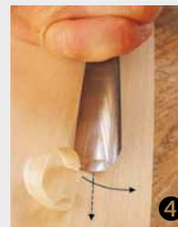
Zur Kontrolle dieser Technik können Sie den beim Schnitt entstandenen Holzspan betrachten. Wenn der ziehende Schnitt richtig durchgeführt wurde, ist der Span leicht in sich gedreht und erinnert an eine langgezogene Locke.
