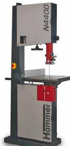
Die X-Life Keramikführungen garantieren hervorragende Schnittergebnisse und maximale Blatt-Stabilität durch vier direkt am Sägeblatt anliegende Führungsblöcke. Die glatte Oberfläche führt zu einer niedrigeren Lärmentwicklung und wesentlich weniger Reibungswiderstand.
