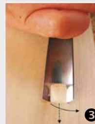
Ähnlich ist die Vorgehensweise bei einem Hohleisen. Auch dieses setzt man etwas aus der Mitte versetzt an. Die seitliche Bewegung während des Schnittes entsteht hier durch eine leichte Drehbewegung am Griff. Mit welcher Seite des Eisens Sie beginnen bzw. in welche Richtung Sie die Drehbewegung durchführen, ist dabei unerheblich. Dies ergibt sich aus Ihrer individuellen Arbeitshaltung, aus der Form des zu bearbeitenden Holzstückes und dem Faserverlauf.
